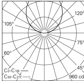
LED 3000 K 24,2 W 2235 lm-h / CIE Flux 0 0 12 1 100 / E03 nach DIN 5040
