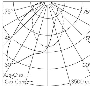
LED 4000 K 42 W 4668 lm-h / CIE Flux 51 81 95 100 100 / A40 nach DIN 5040
