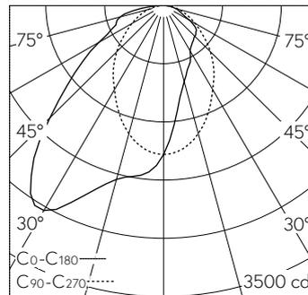
LED 3000 K 42 W 4455 lm-h / CIE Flux 51 81 95 100 100 / A40 nach DIN 5040
