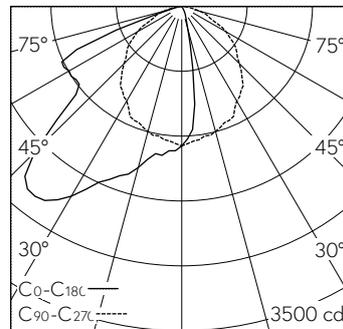
LED 4000 K 29 W 3726 lm-h / CIE Flux 47 80 98 100 100 / A40 nach DIN 5040
