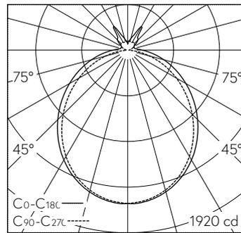
LED 4000 K 35 W 4885 lm-h 108°/98° / CIE Flux 47 77 93 87 100 / B43 nach DIN 5...
