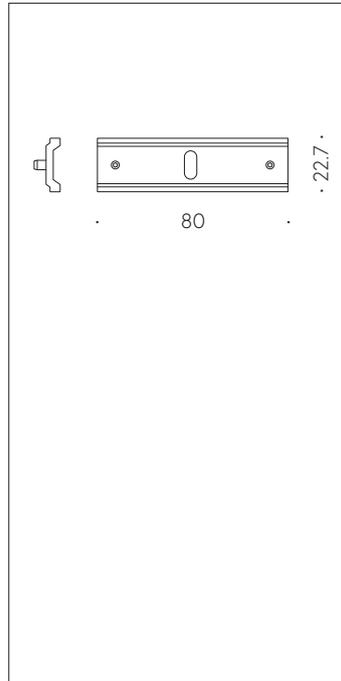
Stromschieneclip für Kabel Ø1.5.
