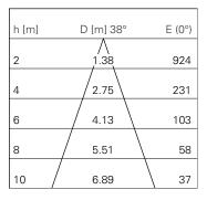
LED 3000 K 20 W 1565 lm-h 38° / CIE Flux 99 100 100 100 100 / A80 nach DIN 5040
