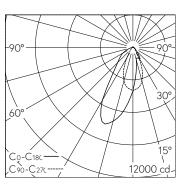
LED 4000 K 33 W 5500 lm-h / CIE Flux 69 90 98 98 100 / A62 nach DIN 5040
