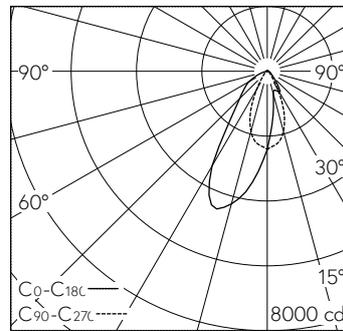
LED 4000 K 20 W 3300 lm-h / CIE Flux 69 90 98 98 100 / A62 nach DIN 5040
