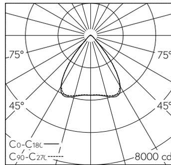
LED 4000 K 33 W 5500 lm-h / CIE Flux 86 96 99 98 100 / A71 nach DIN 5040
