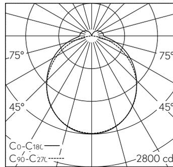
LED 4000 K 47 W 6800 lm-h / CIE Flux 46 76 93 90 100 / A41 nach DIN 5040
