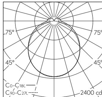
LED 4000 K 39 W 5700 lm-h / CIE Flux 46 76 93 90 100 / A41 nach DIN 5040
