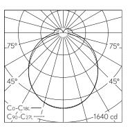
LED 4000 K 31 W 4500 lm-h / CIE Flux 46 76 93 90 100 / A41 nach DIN 5040
