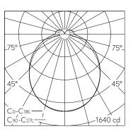
LED 4000 K 31 W 4500 lm-h / CIE Flux 46 76 93 90 100 / A41 nach DIN 5040
