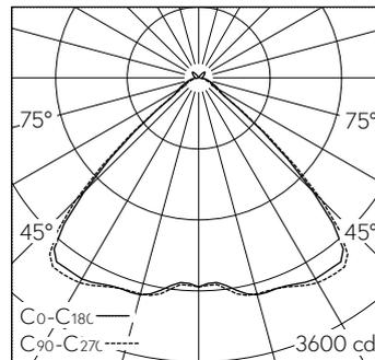
LED 4000 K 47 W 6900 lm-h / CIE Flux 69 95 99 98 100 / A62 nach DIN 5040
