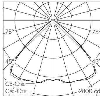
LED 4000 K 39 W 5800 lm-h / CIE Flux 69 95 99 98 100 / A62 nach DIN 5040
