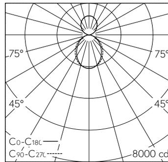
LED 4000 K 70 W 7900 lm-h / CIE Flux 53 83 97 62 100 / B43 nach DIN 5040
