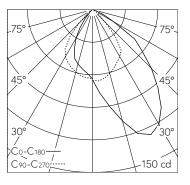
LED 4000 K 1,5 W 131 lm-h / CIE Flux 73 97 100 100 100 / A70 nach DIN 5040
