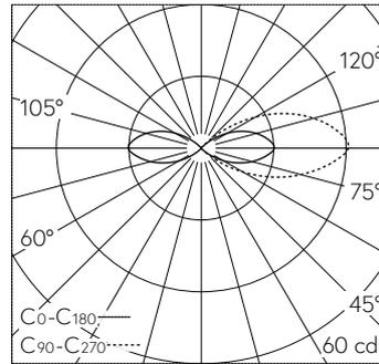
LED 3000 K 7 W 118 lm-h / CIE Flux 1 11 43 47 100 / C11 nach DIN 5040
