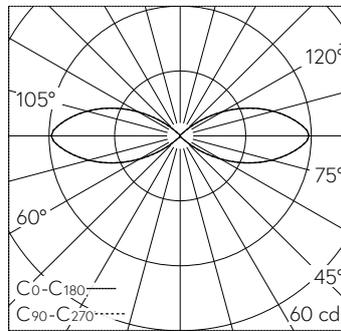
LED 3000 K 7 W 235 lm-h 198° / CIE Flux 1 11 44 50 100 / C11 nach DIN 5040
