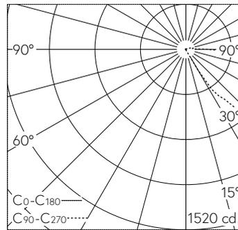
LED 3000 K 14.7 W 1354 lm-h / CIE Flux 7 39 78 98 100 / A10 nach DIN 5040
