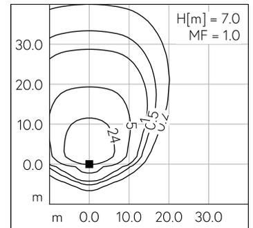
LED 3000 K 134 W 19608 lm-h H = 7 m / CIE Flux 35 71 95 100 100 / A30 nach DIN ...
