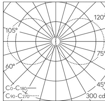
LED 3000 K 27 W 1646 lm-h 102°/66° / CIE Flux 13 37 66 50 100 / C11 nach DIN 5040
