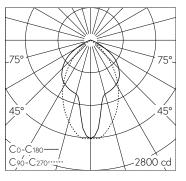
LED 3000 K 53 W 3657 lm-h / CIE Flux 58 88 99 100 100 / A50 nach DIN 5040
