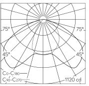
LED 3000 K 43 W 5228 lm-h / CIE Flux 41 79 97 100 100 / A30 nach DIN 5040
