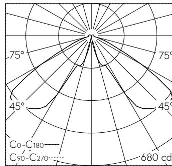
LED 3000 K 18.5 W 1481 lm-h / CIE Flux 33 86 98 97 100 / A31 nach DIN 5040
