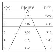
LED 0 K 24 W 1297 lm-h 50° / CIE Flux 93 99 100 100 100 / A80 nach DIN 5040
