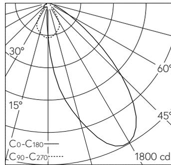
LED 0 K 26 W 1153 lm-h / CIE Flux 72 96 100 100 100 / A60 nach DIN 5040
