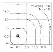
LED 4000 K 60.7 W 7213 lm-h / CIE Flux 13 37 66 50 100 / C11 nach DIN 5040
