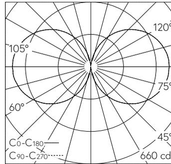
LED 3000 K 51 W 5850 lm-h / CIE Flux 13 37 66 50 100 / C11 nach DIN 5040
