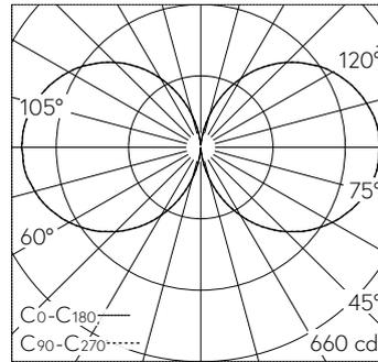
LED 4000 K 51 W 6043 lm-h / CIE Flux 13 37 66 50 100 / C11 nach DIN 5040
