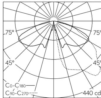
LED 4000 K 7 W 697 lm-h / CIE Flux 32 71 95 100 100 / A20 nach DIN 5040
