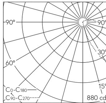
LED 4000 K 14 W 1350 lm-h / CIE Flux 15 47 82 89 100 / B11 nach DIN 5040
