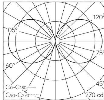
LED 3000 K 17,6 W 2020 lm-h / CIE Flux 13 37 66 50 100 / C11 nach DIN 5040
