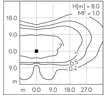
LED 4000 K 33.5 W 4683 lm-h H = 7 m / CIE Flux 34 68 94 100 100 / A20 nach DIN ...
