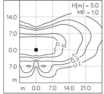
LED 4000 K 33.5 W 4683 lm-h H = 6 m / CIE Flux 34 68 94 100 100 / A20 nach DIN ...
