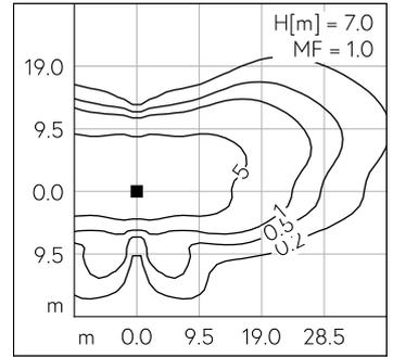
LED 3000 K 51.2 W 6904 lm-h H = 8 m / CIE Flux 34 67 93 100 100 / A20 nach DIN ...
