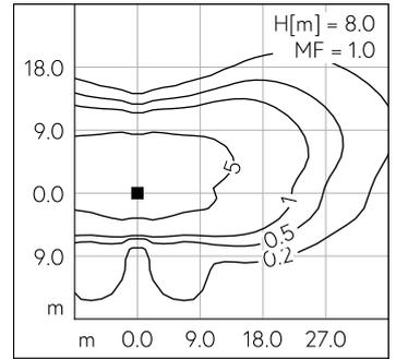
LED 3000 K 33.5 W 4554 lm-h H = 7 m / CIE Flux 34 68 94 100 100 / A20 nach DIN ...
