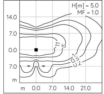
LED 3000 K 33.5 W 4554 lm-h H = 6 m / CIE Flux 34 68 94 100 100 / A20 nach DIN ...
