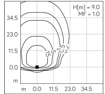
LED 4000 K 134 W 21030 lm-h H = 9 m / CIE Flux 37 74 96 100 100 / A30 nach DIN ...
