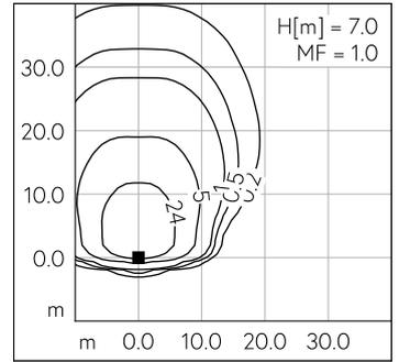
LED 3000 K 67 W 10226 lm-h H = 7 m / CIE Flux 37 74 96 100 100 / A30 nach DIN 5...
