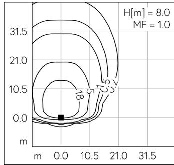
LED 3000 K 67 W 10226 lm-h H = 8 m / CIE Flux 37 74 96 100 100 / A30 nach DIN ...
