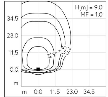
LED 3000 K 67 W 10226 lm-h H = 9 m / CIE Flux 37 74 96 100 100 / A30 nach DIN ...
