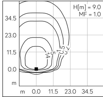
LED 3000 K 67 W 10226 lm-h H = 9 m / CIE Flux 37 74 96 100 100 / A30 nach DIN 5...
