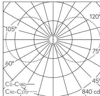
LED 3000 K 51.2 W 3302 lm-h / CIE Flux 13 37 66 50 100 / C11 nach DIN 5040
