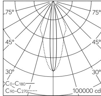
LED 4000 K 312 W 15077 lm-h 11.4°/52° / CIE Flux 97 100 100 100 100 / A80 nach ...
