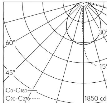
LED 4000 K 20 W 2595 lm-h / CIE Flux 41 77 96 100 100 / A30 nach DIN 5040
