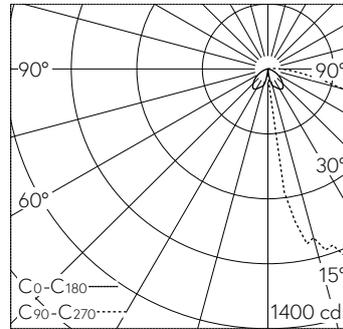
LED 4000 K 13.7 W 1893 lm-h / CIE Flux 37 76 95 100 100 / A30 nach DIN 5040
