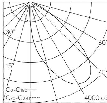
LED 4000 K 26.6 W 2575 lm-h / CIE Flux 66 95 99 100 100 / A60 nach DIN 5040
