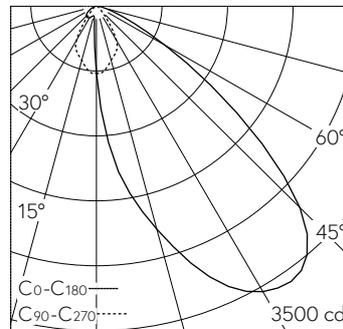
LED 3000 K 26.6 W 2438 lm-h / CIE Flux 66 95 99 100 100 / A60 nach DIN 5040
