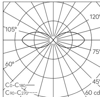
LED 4000 K 5 W 195 lm-h / CIE Flux 1 17 50 50 100 / C11 nach DIN 5040
