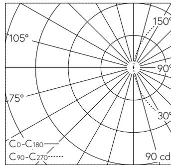
LED 3000 K 3.9 W 323 lm-h / CIE Flux 13 37 66 50 100 / C11 nach DIN 5040
