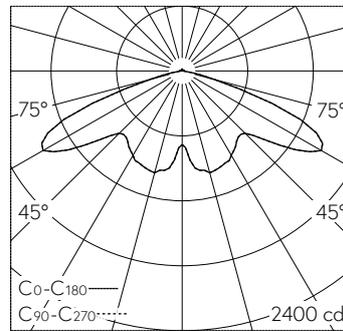
LED 4000 K 39 W 4859 lm-h H = 6 m / CIE Flux 29 65 97 99 100 / A20 nach DIN 5040
