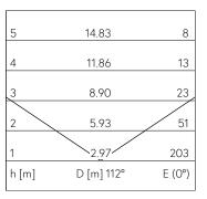
LED 4000 K 7.7 W 569 lm-h 112° / CIE Flux 0 0 0 0 100 / E83 nach DIN 5040
