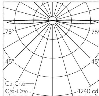
LED 3000 K 21 W 538 lm-h / CIE Flux 0 0 1 75 100 / B01 nach DIN 5040
